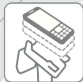
Добавьте возможность считывания RFID, подключив RK26 к считывателю UHF RFID.
