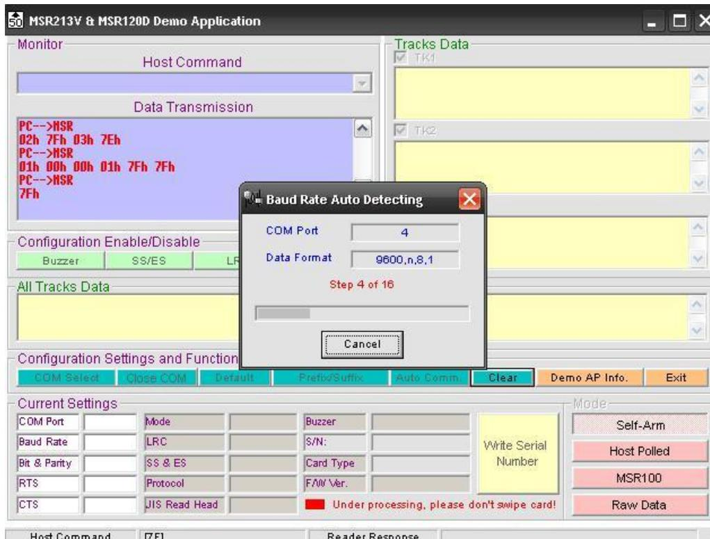
3. Кроме функции автоматического поиска Com порта, к которому подключен считыватель, имеется меню "Com Select" для установки вручную номера и параметров используемого Com порта.
