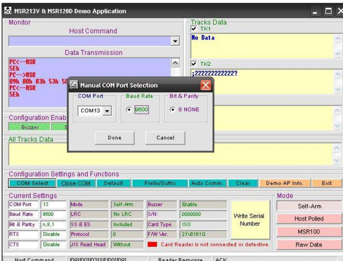
11. После переподключения Com порта, проверяем установленный префикс, считав магнитную карту.
