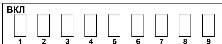
SW1: ВЫКЛ Этот выключатель должен быть в положении ВЫКЛ.
