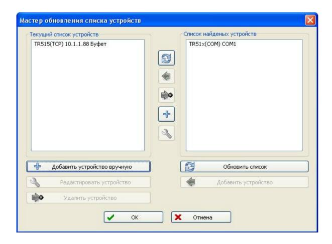
**Обновить список -** будет произведён поиск устройств подключенных к сети. В дальнейшем, они отобразятся в правом списке. Точно так же - будет загружен текущий список устройств в левый список.
