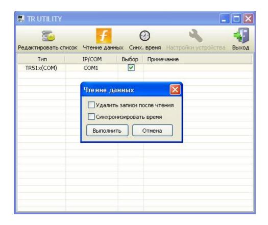
**Удалить записи после чтения -** после считывания записей с устройства, есть возможность очистить базу записей предварительно установив галку.
