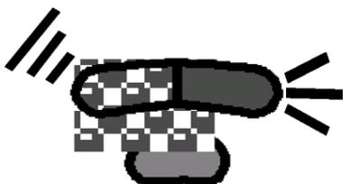
После успешного считывания штрихового кода красный световой индикатор вспыхивает и сканер издает один короткий звуковой сигнал. Если этого не происходит, то штриховой код не был успешно считан.
