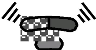
После успешного считывания штрихового кода сканер передает данные штриховой кода в компьютер. Если компьютер не готов получить данные, то включается красный световой индикатор и остается включенным до тех пор, пока данные не будут переданы в компьютер.
