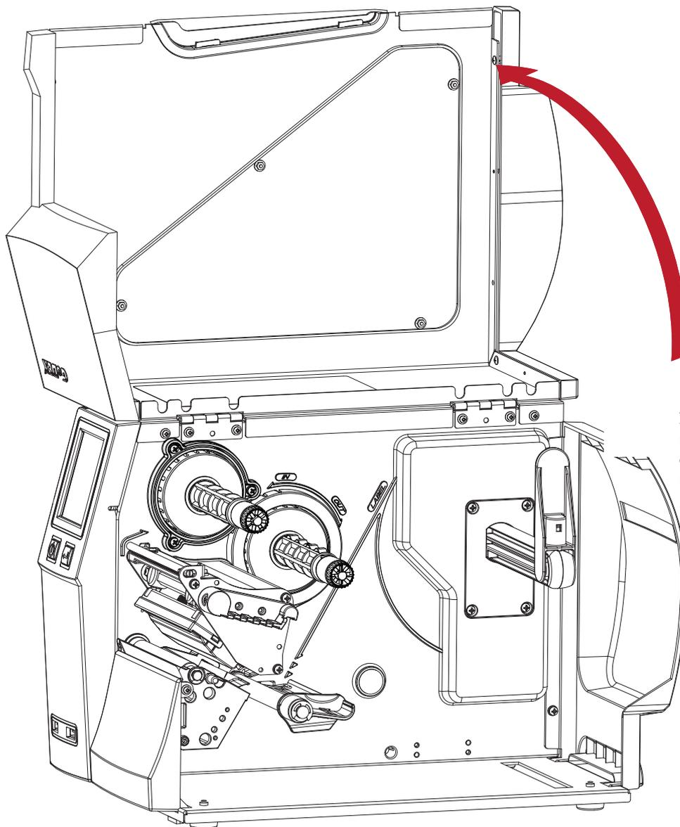
Установите принтер на плоскую поверхность и откройте крышку принтера.
