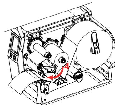
Шаг 4. Поверните рычаг фиксации по часовой стрелке. Принтер готов к печати.
