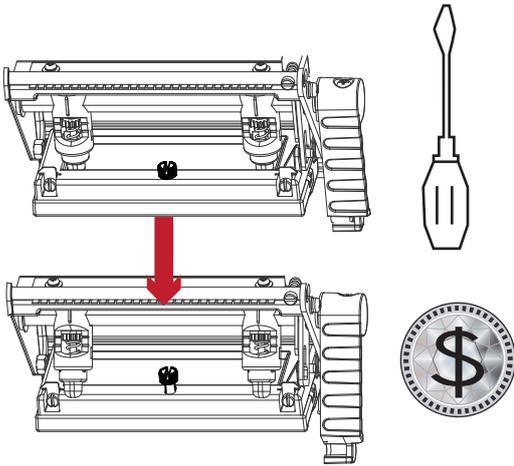
Поверните рычаг фиксации печатающей головки против часовой.
