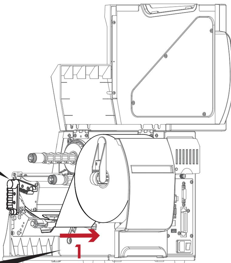
1. Этикетки проходят между стенкой корпуса принтера и регулируемой направляющей для бумаги.
