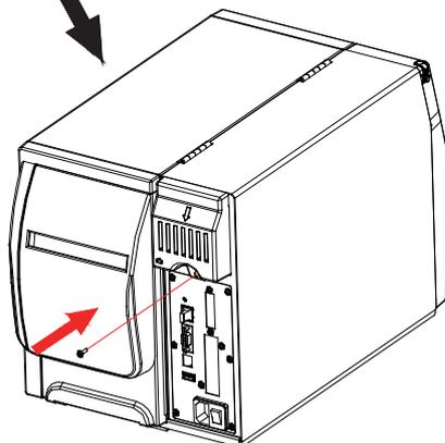
6. Установите крышку отсека и закрутите винты
