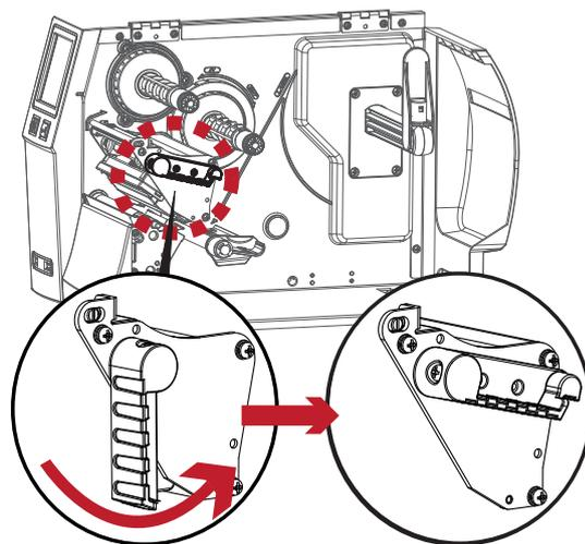
Возьмите модуль печатающей головки за переднюю часть и аккуратно вытяните его. Чтобы установить модуль печатающей головки, произведите действия в обратном порядке.
