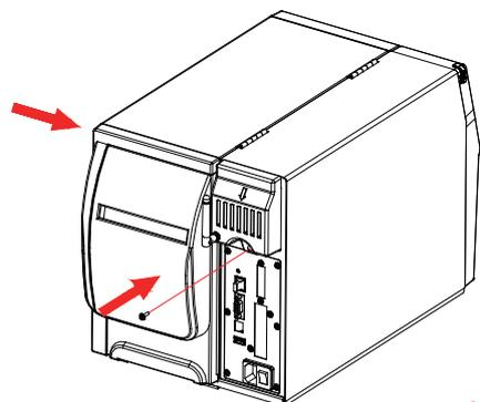
6. Установите крышку отсека и закрутите винты
