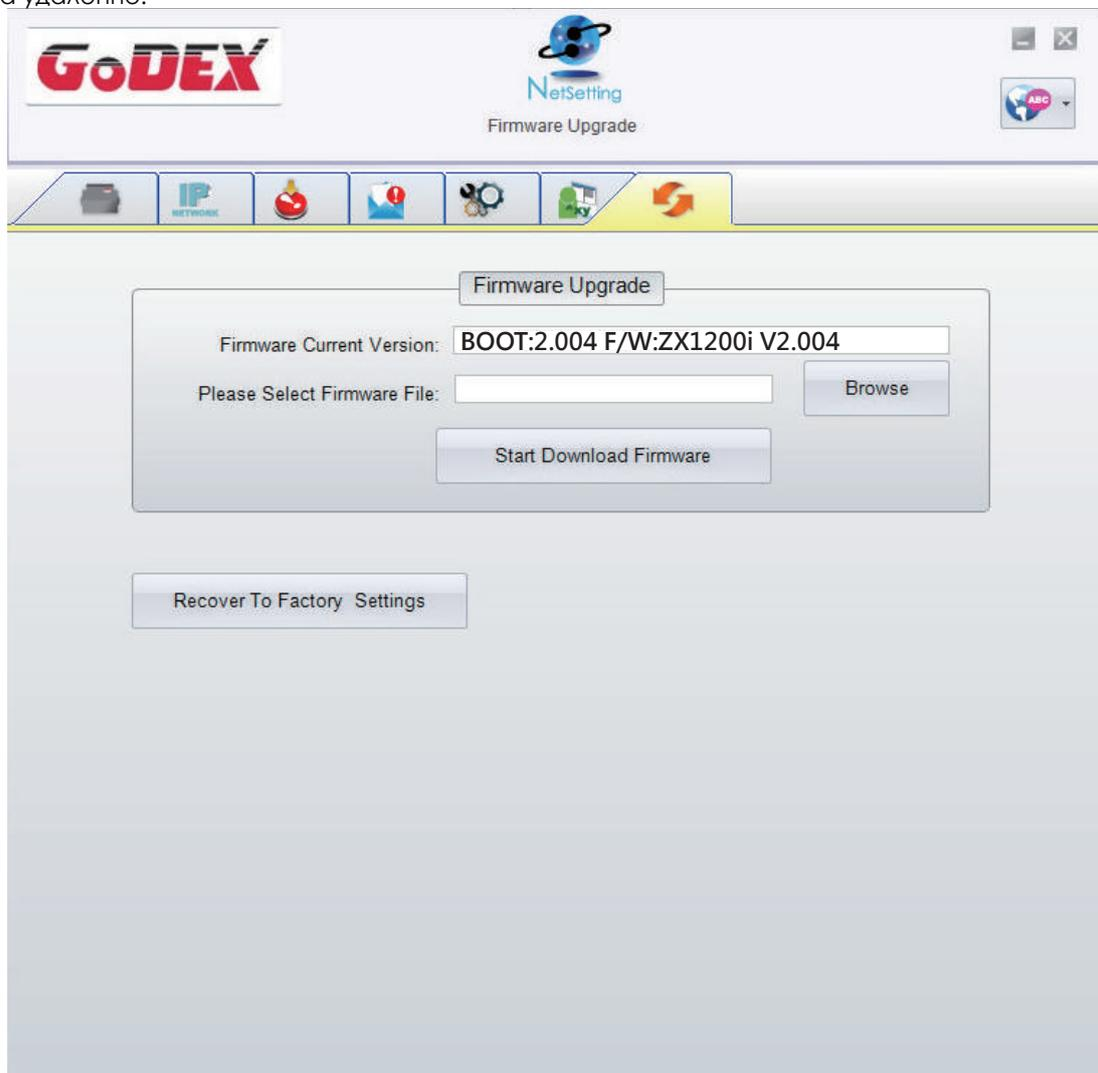
Помимо обновления прошивки, можно нажать кнопку "Recover to factory Settings" ("Сбросить к заводским настройкам"), чтобы вернуть конфигурацию принтера к заводским настройкам по умолчанию.
