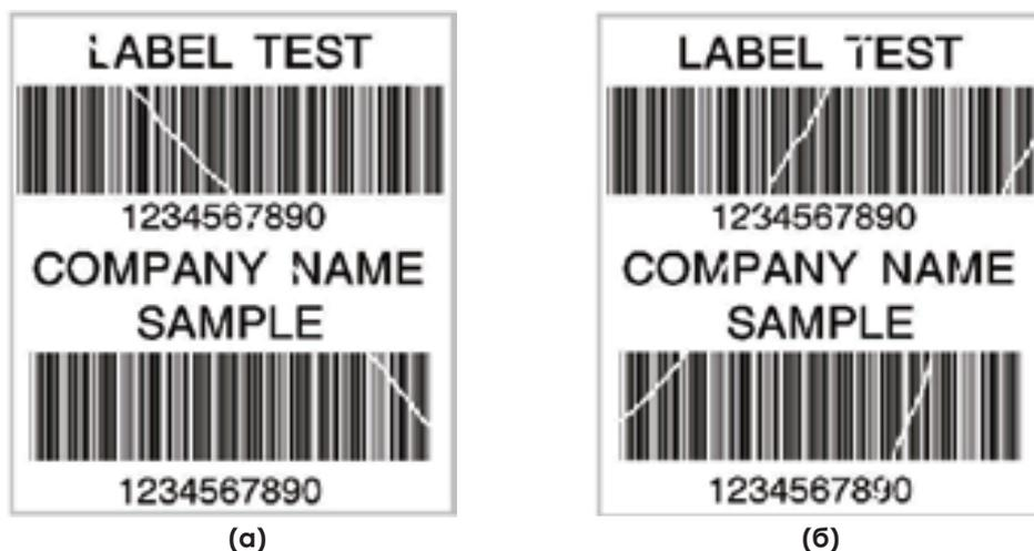
Для отслеживания изменений в качестве печати винты при регулировке следует поворачивать на пол-оборота за раз. Распечатайте тестовую страницу. При отсутствии изменений в качестве печати поверните винт еще на пол-оборота. Не поворачивайте регулировочный винт более, чем на два полных оборота (360°).
