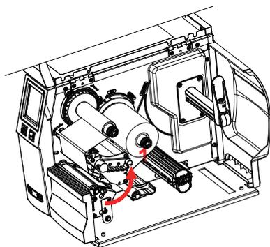
Шаг 1. Поверните рычаг фиксации печатающей головки
