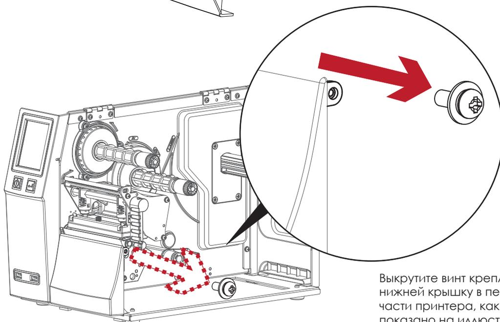
Выкрутите винт крепления нижней крышки в передней части принтера, как показано на иллюстрации.
