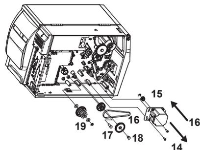
14. Снимите мотор
