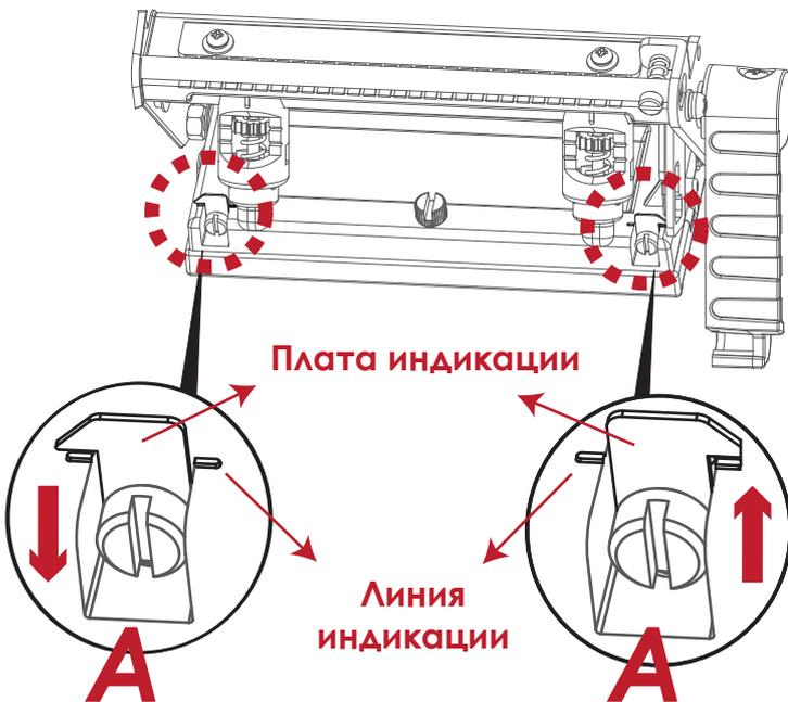
Если улучшений не видно, поверните винты (A) по часовой стрелке или против часовой стрелки, насколько это возможно, и обязательно совместите их с платой индикации и линией индикации. Повторяйте процесс регулировки, пока качество печати не улучшится.
