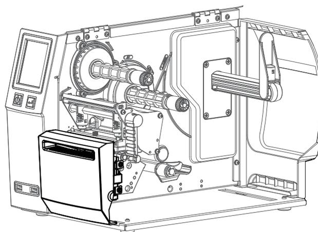
Установите рулон этикетки и термотрансферную ленту и закройте крышку принтера.
